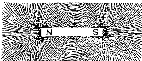
ภาพประกอบ 5 พวงตะไบเหล็กแสดงเส้นแรงแม่เหล็กรอบแท่งแม่เหล็ก (นรินทร์ เนาวประทีป. 2532 : 206)
