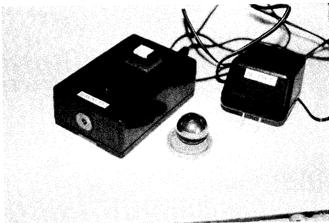
ภาพประกอบ 18 ชุดปล่อยวัตถุแบบแม่เหล็กไฟฟ้า พร้อมลูกกลมเหล็ก
