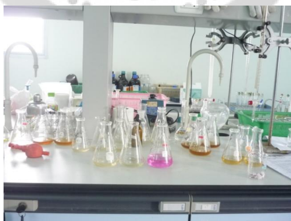
ภาพประกอบ 28 ไซรัปกล้วยนำไปไทเทรตกับ สารละลายโซเดียมไฮดรอกไซด์ 0.1 M
