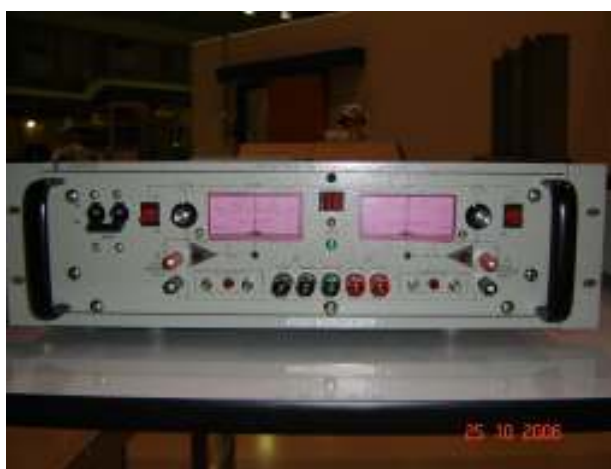
ภาพประกอบ 28 แหล่งจ่ายกำลังกระแสตรง BOP 20-20M ที่ติดตั้งแผ่นวงจรต่อประสาน BIT 4886 ไว้ภายใน
