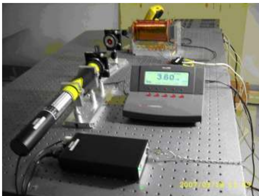
ภาพประกอบ 47 องค์ประกอบและการจัดวางอุปกรณ์ของระบบการวัด P-MOKE ของข้าวแม่เหล็กแบบที่ 2
