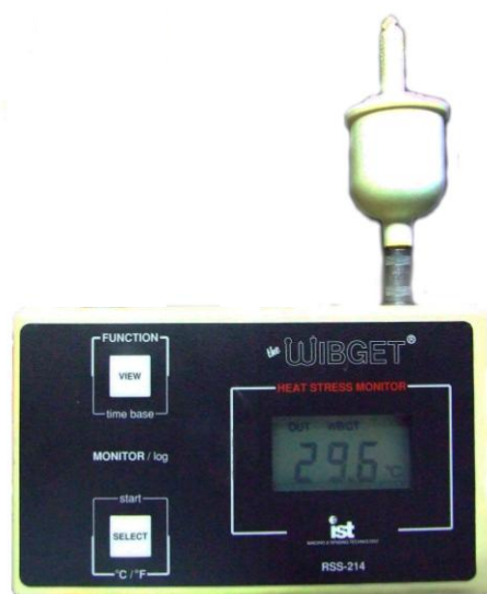
ภาพประกอบ 4 เทอร์โมมิเตอร์กระเปาะเปียกตามธรรมชาติ (Natural Wet Bulb Thermometer; NWB)
