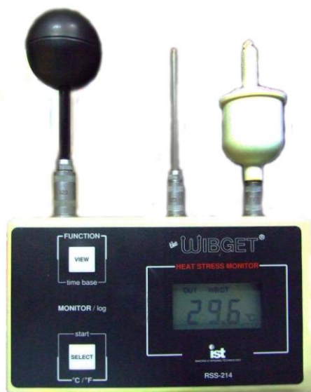
ภาพประกอบ 7 แสดงเครื่องมือการตรวจวัดดัชนีภาวะเปียกและโกลบ (Wet Bulb Globe Thermometer; WBGT) ด้วยเครื่องรุ่น RSS – 214 DL
