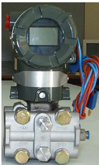
ภาพประกอบ 35 เครื่องมือวัดความดันตกคร่อม YOKOGAWA รุ่น EJA 110A
