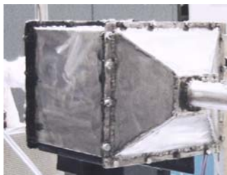
ภาพประกอบ 21 เครื่องแลกเปลี่ยนความร้อนขนาดกะทัดรัด
