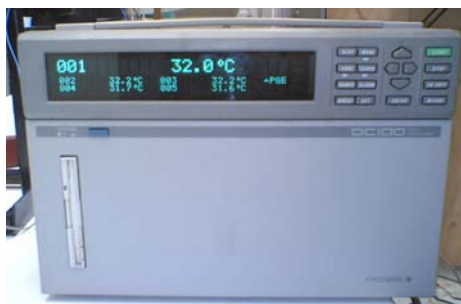
ภาพประกอบ 33 ระบบบันทึกข้อมูล YOKOGAWA DC 100
