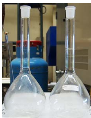
ภาพประกอบ 27 กระจกตวงวัดอัตราการไหลเชิงมวลของน้ำ ขนาด 0.5 liter
