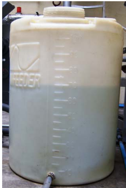
ภาพประกอบ 26 ถังน้ำป้อนขนาด 100 liter
