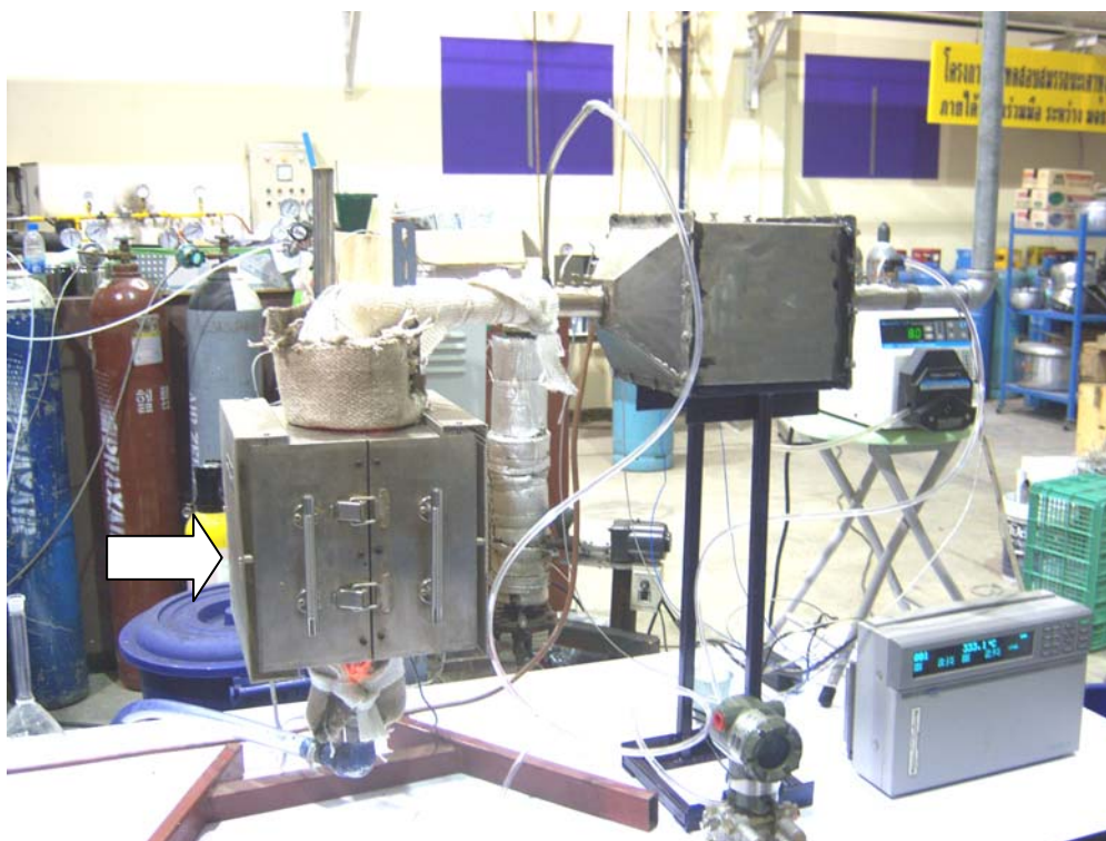
ภาพประกอบ 29 เครื่องกำเนิดความร้อน
