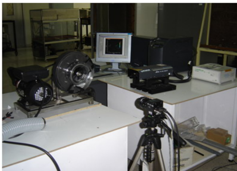
ภาพประกอบ 47 การติดตั้งอุปกรณ์ทดสอบและเครื่องมือวัดความเร็วของของไหลโดยใช้เทคนิค วิธีการถ่ายภาพอนุภาคแบบ Particle Image Velocimetry (PIV)
