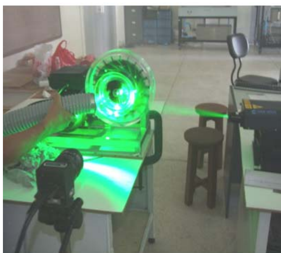
ภาพประกอบ 49 การทดสอบดีฟิวเซอร์โดยใช้เงื่อนไขของอากาศ
