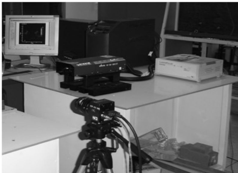
ภาพประกอบ 43 เครื่องมือวัดความเร็วของของไหลโดยใช้เทคนิควิธีการถ่ายภาพอนุภาคแบบ Particle Image Velocimetry (PIV)
