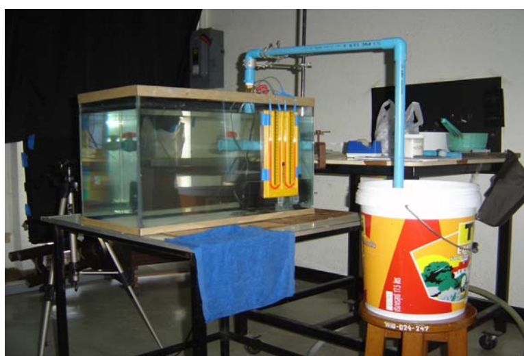
ภาพประกอบ 55 การติดตั้งอุปกรณ์วัดอัตราการไหล
