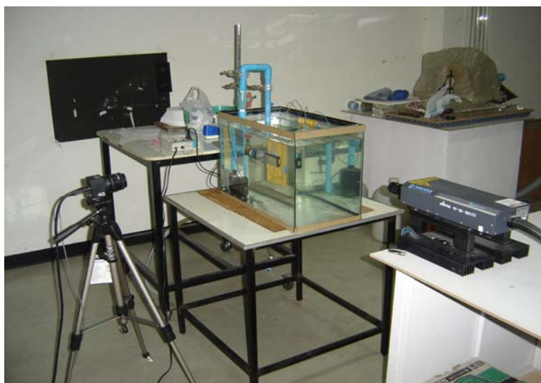
ภาพประกอบ 58 การติดตั้งอุปกรณ์ทดสอบและเครื่องมือวัดความเร็วของของไหลโดยใช้เทคนิค วิธีการถ่ายภาพอนุภาคแบบ Particle Image Velocimetry (PIV)
