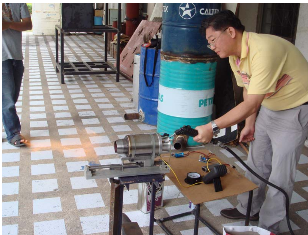
ภาพประกอบ 56 แสดงการทดสอบเครื่องยนต์เจ็ทครั้งที่ 2 ขณะทำการเริ่มสตาร์ทเครื่องยนต์
