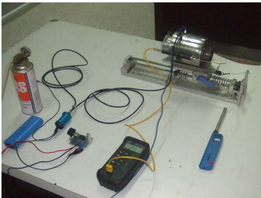
ภาพประกอบ 54 แสดงการติดตั้งเครื่องยนต์เจ็ทขนาดเล็กในการทดสอบ
