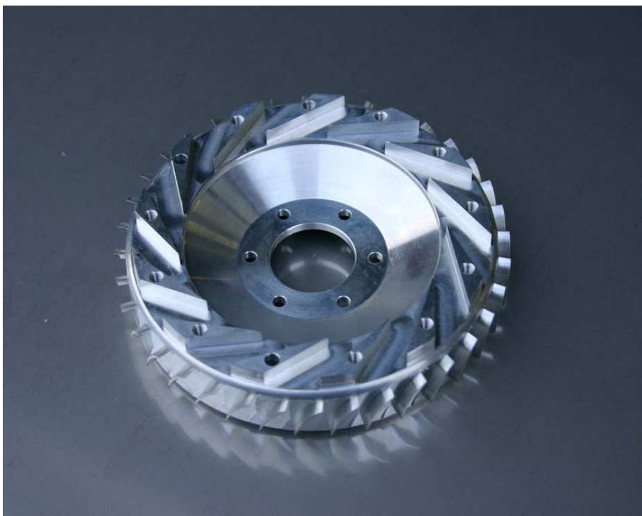
ภาพประกอบ 47 แสดง Diffuser ที่ปรับปรุงใหม่
