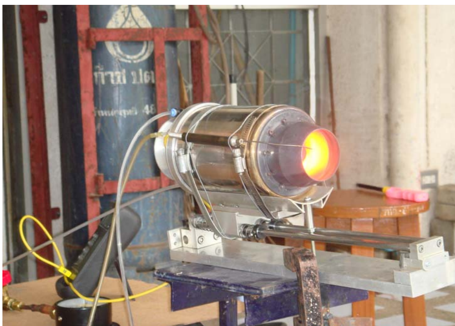
ภาพประกอบ 61 แสดงการทดสอบเครื่องยนต์เจ็ทครั้งที่ 3 ขณะทำการดับเครื่องยนต์ เนื่องจาก อุณหภูมิสูงมาก
