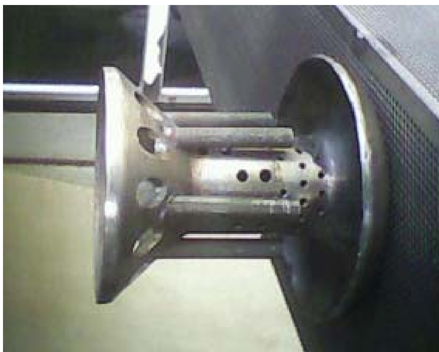
ภาพประกอบ 37 แสดง Combustion Inner & Burner Tube
