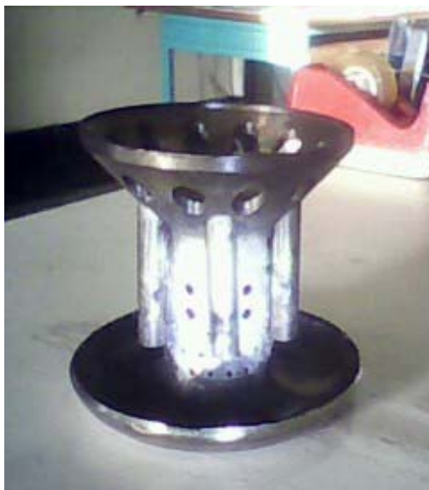
ภาพประกอบ 62 แสดงการทดสอบเครื่องยนต์ครั้งที่ 4 ปรับปรุงท่อน้ำมัน (Vaporizer tube)
