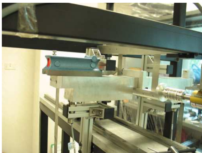
ภาพประกอบ 20 แสดงการปรับระดับของคานโดยใช้ระดับน้ำ
