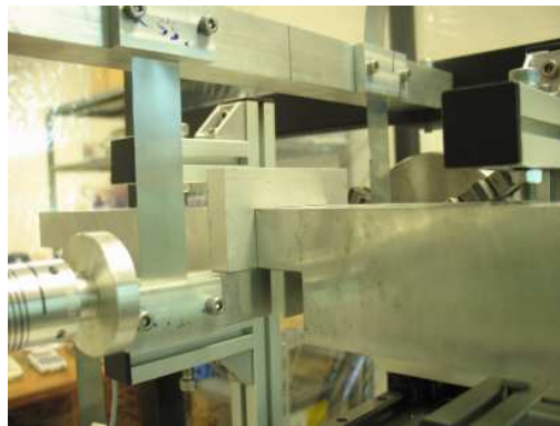
ภาพประกอบ1 การใช้แผ่นโลหะบางเป็นจุดศูนย์กลางทอร์ก
