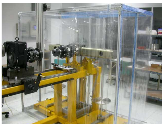
ภาพประกอบ 17 แสดงเครื่องวัดทอร์กมาตรฐานปฐมภูมิ 1,000 Nm
