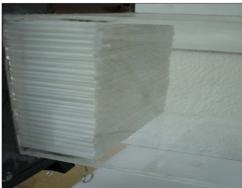
ภาพประกอบ 13 แสดงลักษณะของ STRAIGHTENER
