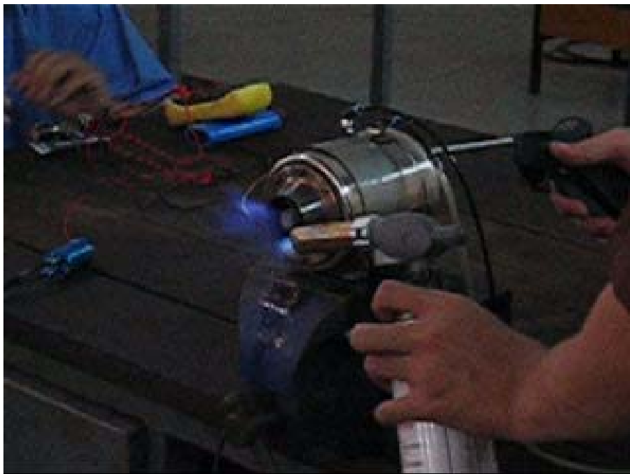
ภาพประกอบ 51 แสดงการทดสอบเครื่องยนต์เจ็ทครั้งที่ 4 ขณะทำการเริ่มการสตาร์ทและปล่อยแก๊สเข้าไปในห้องเผาไหม้
