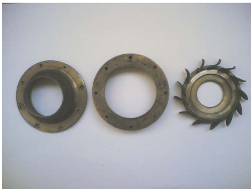
ภาพประกอบ 30 แสดง Nozzle guide vane
