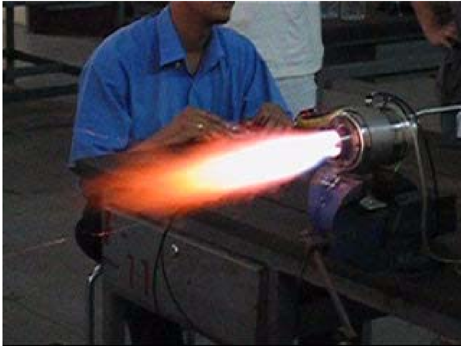
ภาพประกอบ 52 แสดงการทดสอบเครื่องยนต์เจ็ทครั้งที่ 4 ขณะเริ่มทำการปล่อยน้ำมันเข้าห้องเผาไหม้
