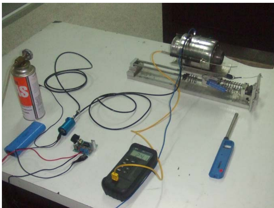
ภาพประกอบ 44 แสดงการติดตั้งเครื่องยนต์เจ็ทขนาดเล็กในการทดสอบ
