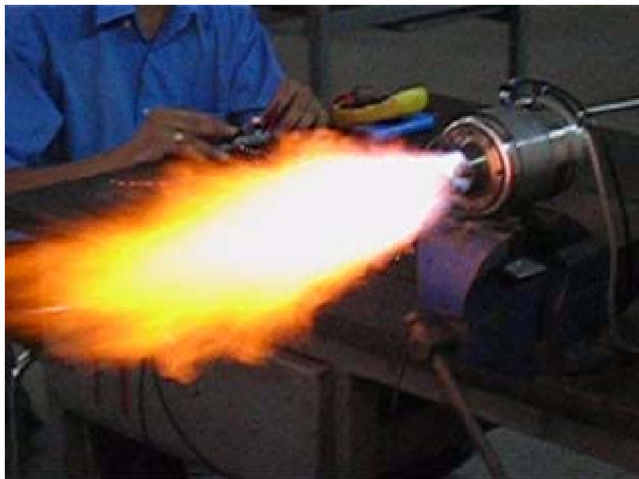
ภาพประกอบ 53 แสดงการทดสอบเครื่องยนต์เจ็ทครั้งที่ 4 เมื่อนำเอาสายลมที่ใช้ในการสตาร์ทออก ความเร็วรอบเริ่มช้าลง
