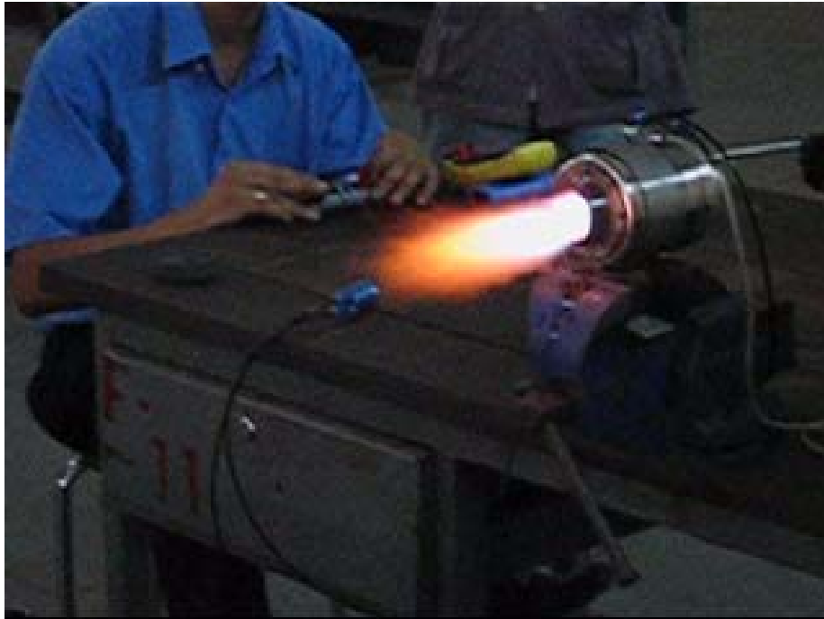
ภาพประกอบ 57 แสดงการทดสอบเครื่องยนต์เจ็ทครั้งที่ 5 เครื่องยนต์ทำงานที่รอบเดินเบา
