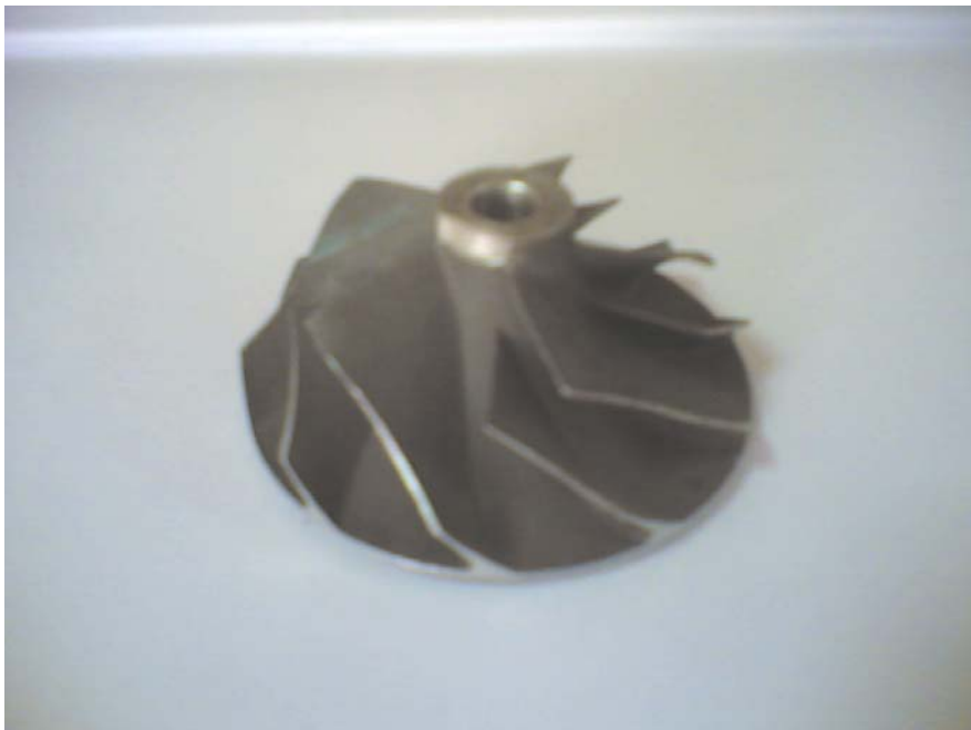
ภาพประกอบ 36 แสดง Compressor Wheel
