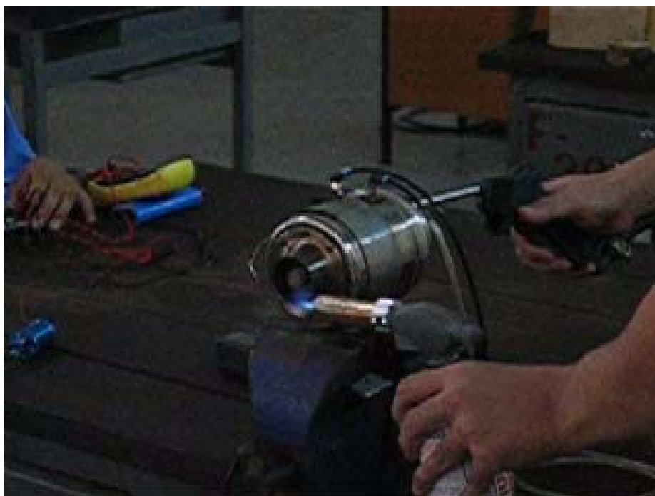
ภาพประกอบ 54 แสดงการทดสอบเครื่องยนต์เจ็ทครั้งที่ 5 ขณะเริ่มทำการสตาร์ทเครื่องยนต์
