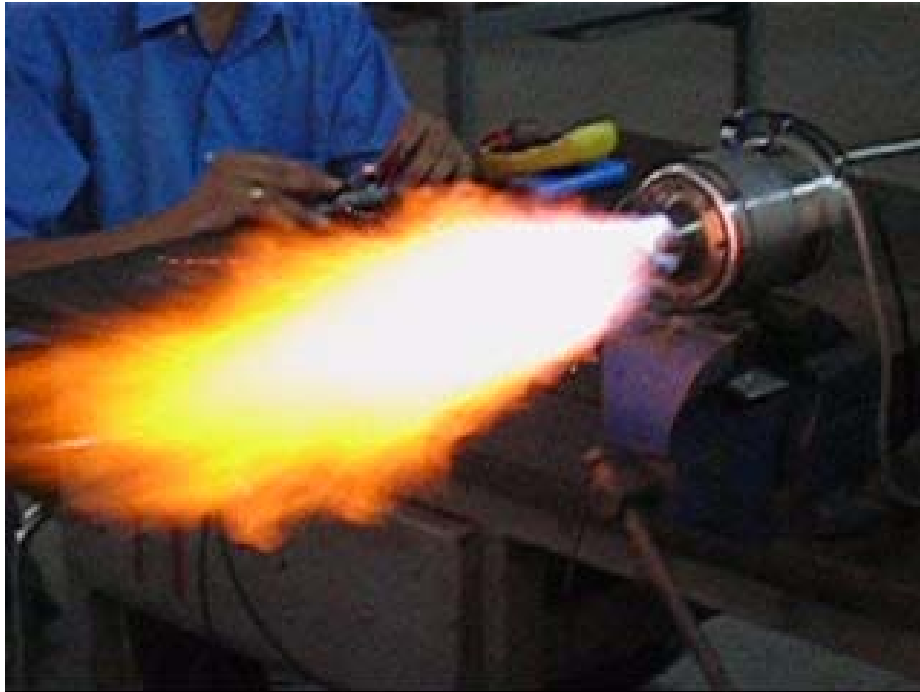
ภาพประกอบ 55 แสดงการทดสอบเครื่องยนต์เจ็ทครั้งที่ 5 ขณะเริ่มทำการปล่อยน้ำมันเข้าไปในห้องเผาไหม้
