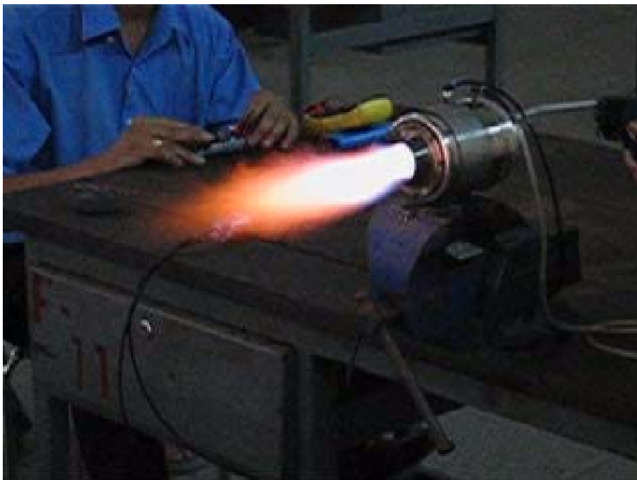
ภาพประกอบ 56 แสดงการทดสอบเครื่องยนต์เจ็ทครั้งที่ 5 ขณะเริ่มทำการเร่งความเร็วให้ถึงรอบเดินเบา
