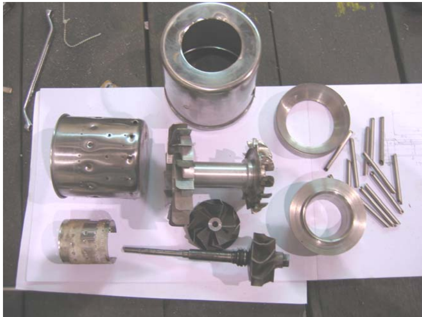
ภาพประกอบ 29 แสดงชิ้นส่วนของเครื่องยนต์เจ็ทขนาดเล็ก
