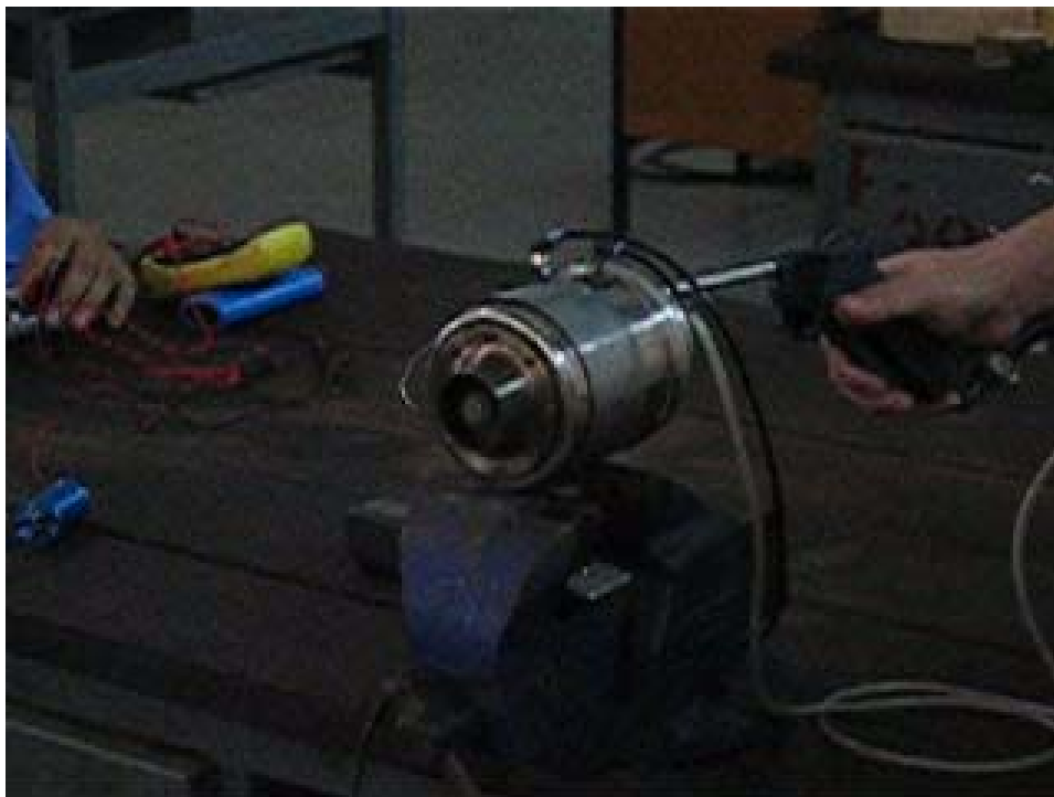
ภาพประกอบ 46 แสดงการทดสอบเครื่องยนต์เจ็ทครั้งที่ 2 ขณะที่เริ่มสตาร์ทเครื่องยนต์
