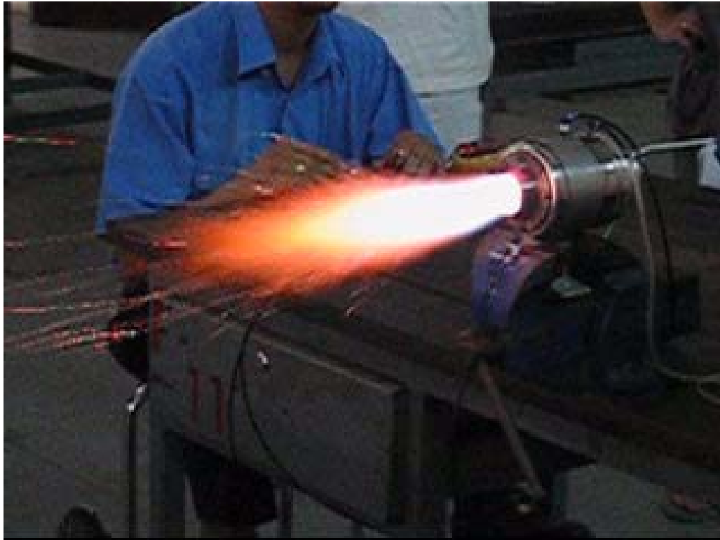
ภาพประกอบ 47 แสดงการทดสอบเครื่องยนต์เจ็ทครั้งที่ 2 ขณะเครื่องเริ่มเกิดการเสียดสี ระหว่าง turbine wheel กับ NGV ทำให้เกิดสะเก็ดไฟออกมาทางด้านท้ายเครื่องยนต์
