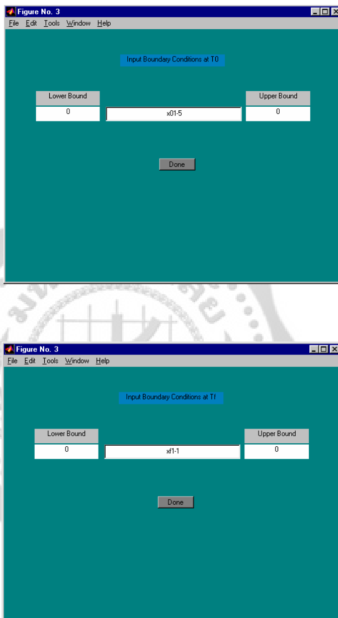
ภาพประกอบ 4.8 แสดงการกำหนดเงื่อนไขขอบเขต (Boundary condition) ทั้งสองเงื่อนไข ที่ t_0 และ t_f
