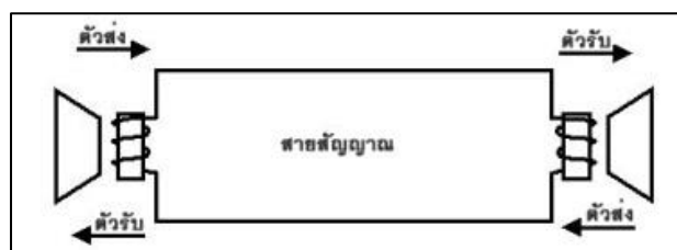
ภาพประกอบ 4 หลักการโทรศัพท์ของ Bell
