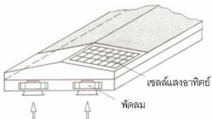
ภาพประกอบ 34 แผงโซลาร์เซลล์และพัดลมที่ติดตั้งเข้ากับเครื่องอบแห้งแบบอุโมงค์ลม ที่มา: กรมพัฒนาพลังงานทดแทนและอนุรักษ์พลังงานกระทรวงพลังงาน. (2547). เครื่อง อบแห้งพลังงานแสงอาทิตย์ . หน้า 23. (อ้างอิงจาก Esper. (1994).)
