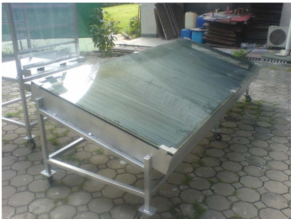
ภาพที่ 2 แสดงแผงรับแสงอาทิตย์ของเครื่องอบแห้งพลังงานแสงอาทิตย์
