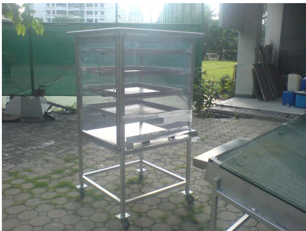
ภาพที่ 3 แสดงตู้เก็บของของเครื่องอบแห้งพลังงานแสงอาทิตย์
