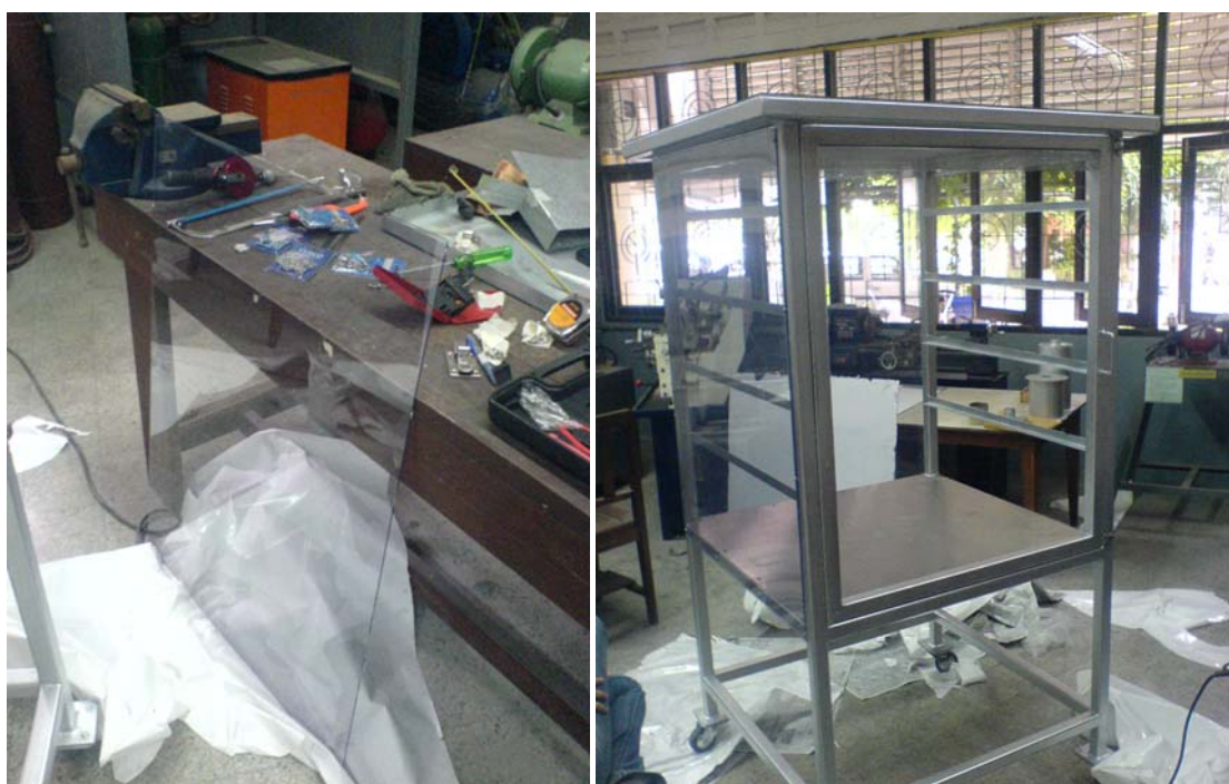
การติดตั้งอุปกรณ์และแผ่นพลาสติกใสที่ตู้อบแห้ง
