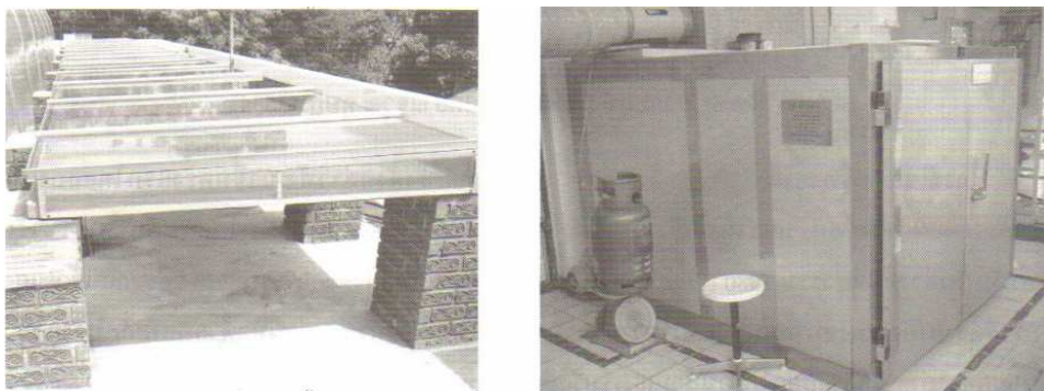
ภาพประกอบ 31 เครื่องอบแห้งพลังงานแสงอาทิตย์ระดับอุตสาหกรรมที่พัฒนาโดย เจนชัย ที่มา: กรมพัฒนาพลังงานทดแทนและอนุรักษ์พลังงานกระทรวงพลังงาน. (2547). เครื่อง อบแห้งพลังงานแสงอาทิตย์. หน้า 19. (อ้างอิงจาก เจนชัย. (2543).)
