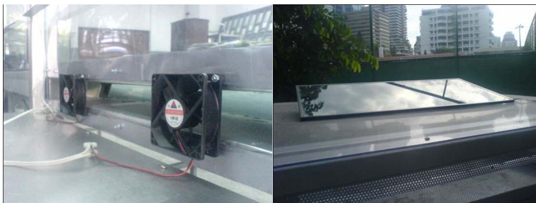
ภาพที่ 4 แสดงชุดพัดลมพาความร้อนและเซลล์แสงอาทิตย์
