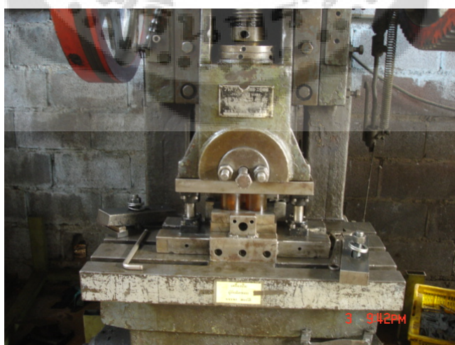
ภาพประกอบ 42 แสดงการนำแม่พิมพ์ตัดเหล็กเพลากลมขึ้นวางบนเครื่องปั๊ม
