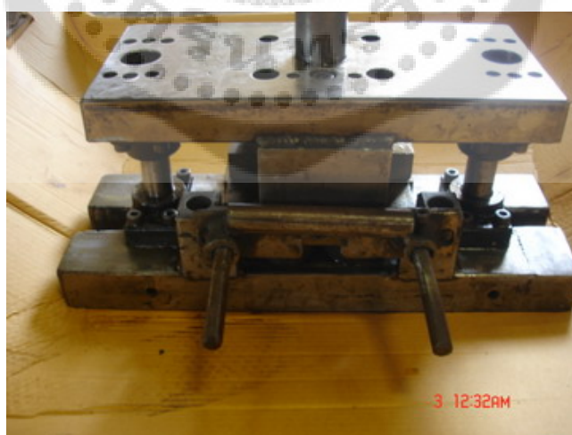
ภาพประกอบ 40 แสดงชิ้นส่วนและการประกอบแม่พิมพ์ตัดเหล็กเพลากลม ขนาดเส้นผ่าศูนย์กลาง 20 มิลลิเมตร
