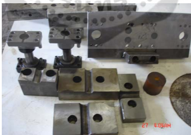
ภาพประกอบ 37 แสดงชิ้นส่วนและการประกอบแม่พิมพ์ตัดเหล็กเพลากลม ขนาดเส้นผ่าศูนย์กลาง 20 มิลลิเมตร
