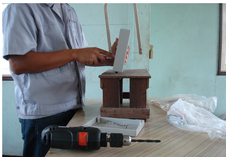
ภาพประกอบ 66 แสดงการตัดกล่องพลาสติกเพื่อใส่อุปกรณ์
