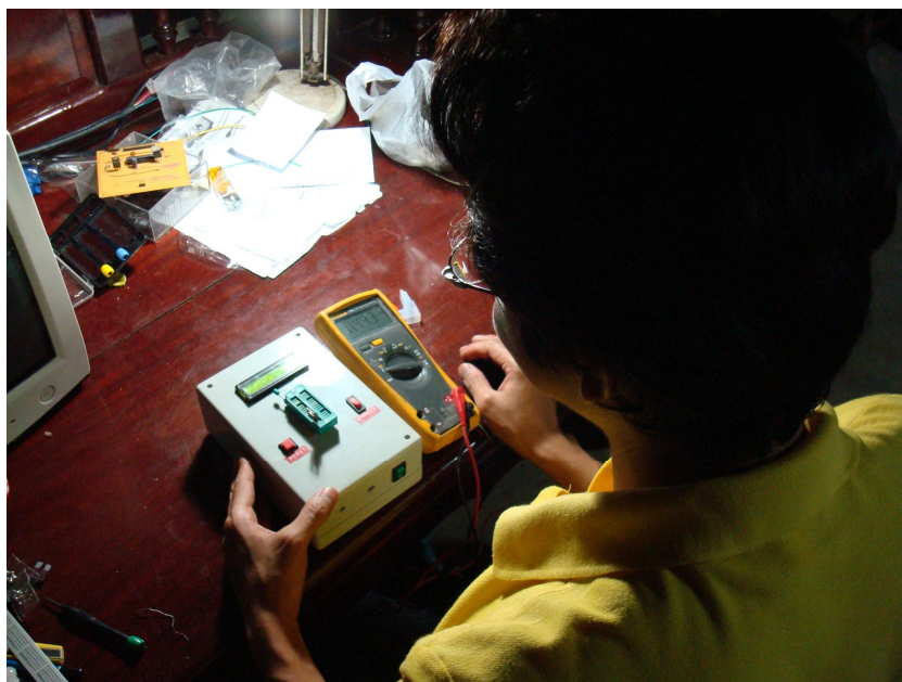
ภาพประกอบ 74 แสดงผู้เชี่ยวชาญทดสอบเครื่องตรวจสอบไดโอด ทรานซิสเตอร์ และเฟท
