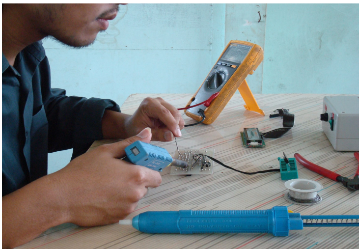
ภาพประกอบ 71 แสดงการบัดกรีเพื่อต่ออุปกรณ์เพื่อใช้งานจริง
