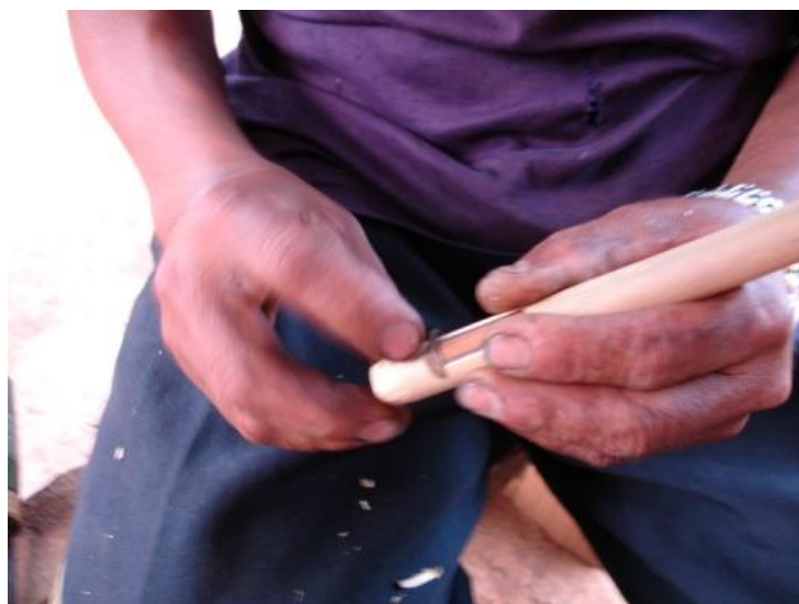
ภาพประกอบ 75 ติดขี้สูดเพื่อยึดลื่นกับไม้ไผ่เฮี้ยะไว้ด้วยกัน
