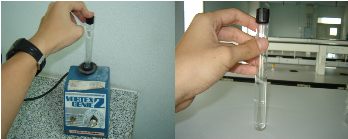
ภาพประกอบ 17 การสกัดสารกำจัดศัตรูพืชกลุ่มออร์กาโนคลอรีนในตัวอย่างน้ำด้วยวิธีการสกัดด้วยตัวทำละลายแบบขั้นตอนเดียว
