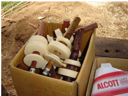
ภาพประกอบ 58 หัวกรงที่นำแผ่นพลาสติกมาประกอบเข้าด้วยกัน
