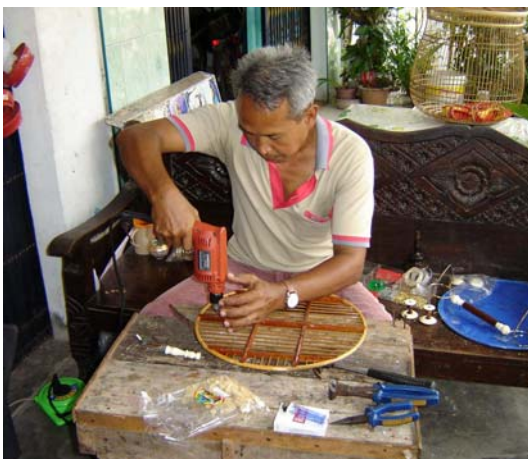
ภาพประกอบ 73 การเจาะรูเพื่อใส่คอนสำหรับนกจับ
