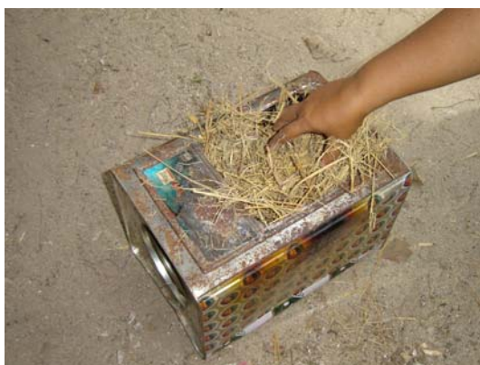
ภาพประกอบ 31 การนำฟางใส่ในเตาเผา
