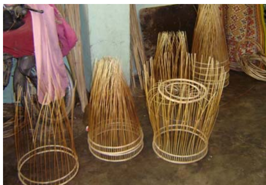
ภาพประกอบ 39 การนำหวายใส่ซี่กรง
