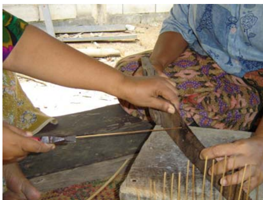
ภาพประกอบ 28 การเหลาไม้ไผ่ด้วยแป้นชัก
