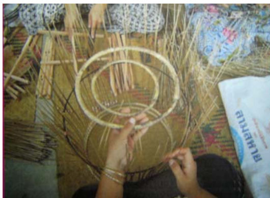
ภาพประกอบ 40 การนำเหล็กวงกลมใส่ตรงกึ่งกลางของกรง
