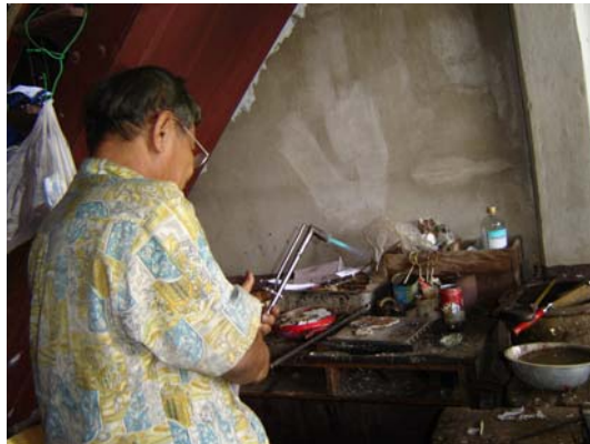
ภาพประกอบ 64 การเชื่อมตะขอแขวนเพื่อเป็นแกนข้างใน
