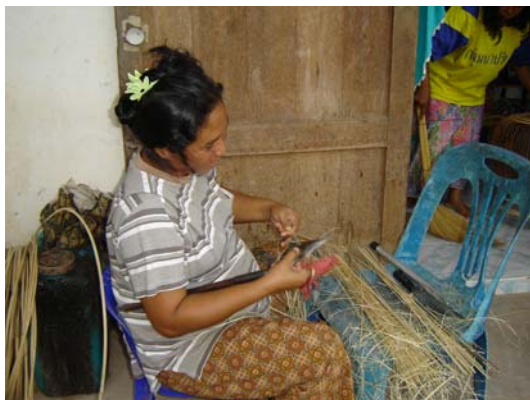
ภาพประกอบ 27 การเหลาซี่ไม้ไผ่ด้วยมีดตอก
