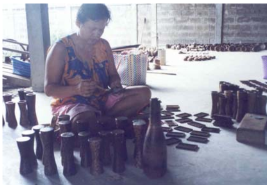
ภาพประกอบ 35 การทำน้ำมันชิลเลอร์ผสมกับทินเนอร์ ก่อนขัดด้วยกระดาษทราย
