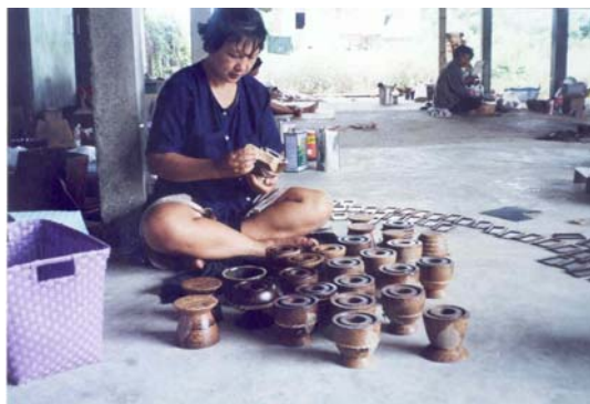
ภาพประกอบ 37 การใช้เล็คเกอร์หรือน้ำมันพืช สีกัด ทาเคลือบให้เกิดความมันเงา
