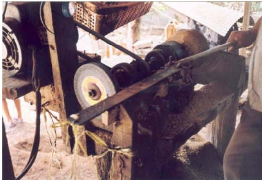
ภาพประกอบ 27 การประกอบไม้ตาลโดนคให้เข้ากับเครื่องกลึง
